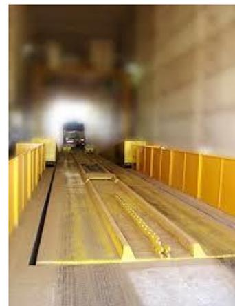
O auxiliar de operações deve abrir as tampas traseiras da carroceria do veículo, sempre observando se as travas estão em condições seguras para abertura. Utilizar ferramenta apropriada em caso de tampas emperradas e nas travas dos basculantes. O operador de terminal III (tombador) aciona a elevação do tombador para iniciar a descarga, sendo também o responsável por certificar que o motorista está portando todos os EPI's obrigatórios, já orientado na entrada do terminal.
