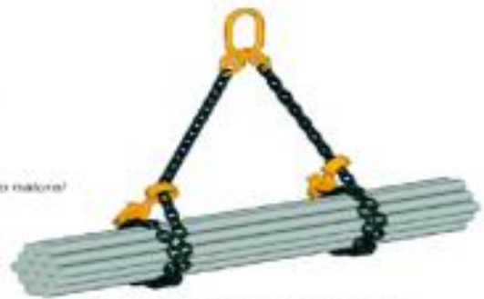
Amarragem em força com duas pernas
