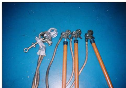
O 'jumpeamento' das fases e sua conexão com uma estrutura aterrada logo abaixo do local de trabalho deixará o colaborador em paralelo com uma mínima resistência.
