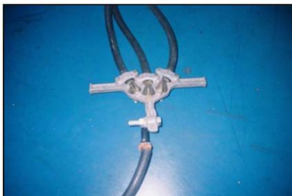
Outra tentativa para se obter um resultado mais satisfatório pode ser obtida através da redução do comprimento dos cabos e da resistência entre as fases pela prática do 'jumpeamento' direto de uma fase a outra. Isso, porém não eliminaria a resistência de aterramento no local de trabalho e a conseqüente queda de tensão através do colaborador.
