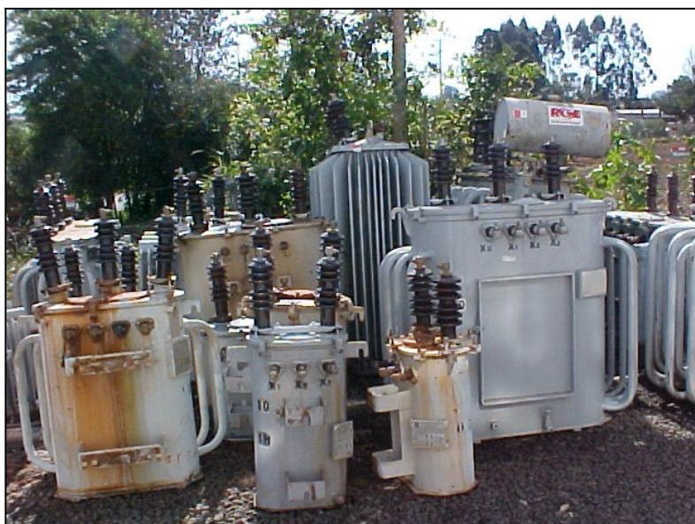
Na foto acima são vistos transformadores monofásicos e trifásicos avariado aguardando recondiçãoamento
