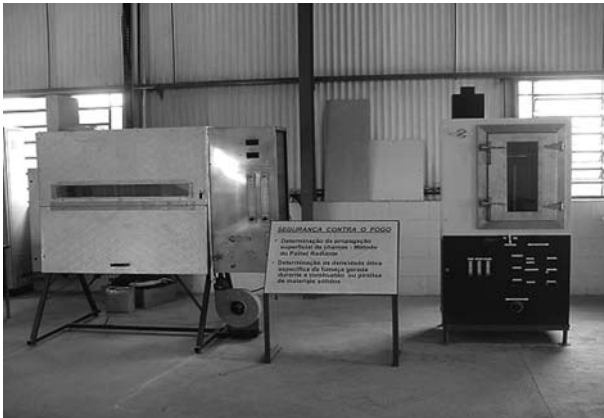
FIGURA 2: à esquerda tem-se o equipamento para ensaio em materiais de piso, e à direita a câmara de determinação da densidade ótica específica da fumaça
