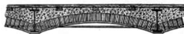
FIGURA 1 - O arco de tijolos como primeira forma de proteção de vigas metálicas
