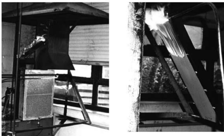
FIGURA 5 - Equipamento de ensaio para a verificação da propagação superficial de chama e detalhe de corpo-de-prova durante processo de combustão
