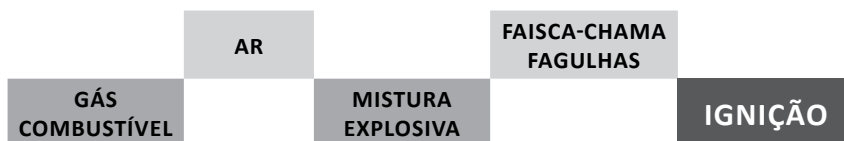
Figura 6: Mecanismo de ignição do combustível gasoso
