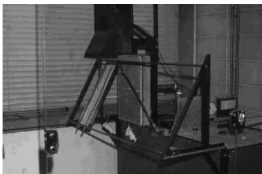
FIGURA 1: Painel radiante para determinação da propagação superficial da chama de materiais de construção, revestimento e acabamento
