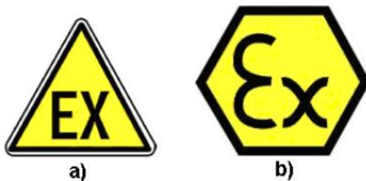
Figura 1 - Simbologia para Áreas Classificadas. a) Simbologia para área; b) Simbologia para equipamento..
