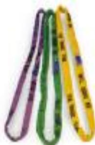
Fita de Inspeção Alguns fabricantes instalam uma fita extra no corpo da cinta, o que garante a correta inspeção de cortes laterais. O aparecimento da fita de inspeção indica que o corte lateral foi superior ao permitido por norma e a cinta deve ser retirada de uso.
