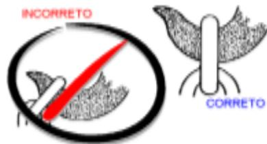
Nunca faça o içamento de uma carga se o gancho não estiver posicionado na vertical em relação a carga, ou então o ponto de sustentação da carga estiver fora da sela do gancho. O operador ao usar o acessório de içamento, deverá deixá-los com folga para o engate correto do gancho.
