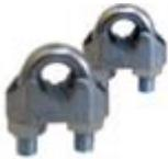
Outro aspecto importante para a conservação e para um bom rendimento dos cabos de aço, é a correta colocação dos grampos (também chamados de clips) em suas extremidades. Para cabos de diâmetro até 5/8" (16 mm) use, no mínimo, três grampos. Este número deve ser aumentado quando se lida com cabos de diâmetros superiores.
