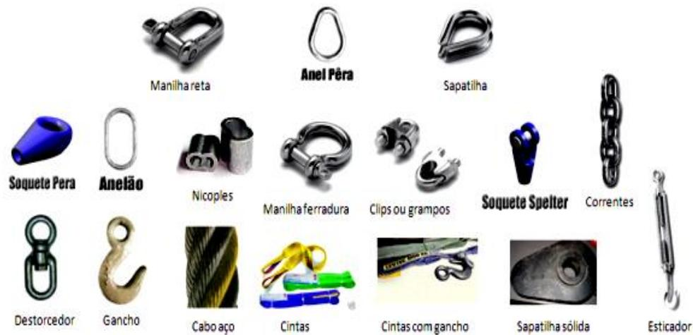
São dispositivos utilizados para a melhor conexão (engate) do gancho e carga.
