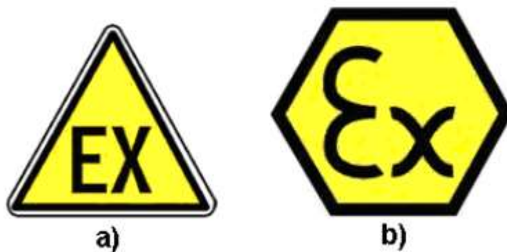
Figura 1 - Simbología de áreas clasificadas. a) Simbología por área; b) Simbología de los equipos.
