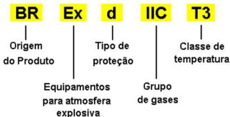
Figura 18 - Marcação em Equipamentos Ex.
